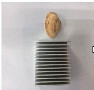
ヒートシンク冷却フィンと あさりの貝殻浸漬前
